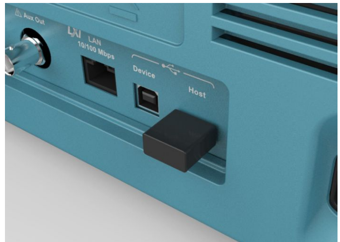
統合された設定メニューで Wi-Fi アダプタを設定することにより、シームレスな無線通信が可能
